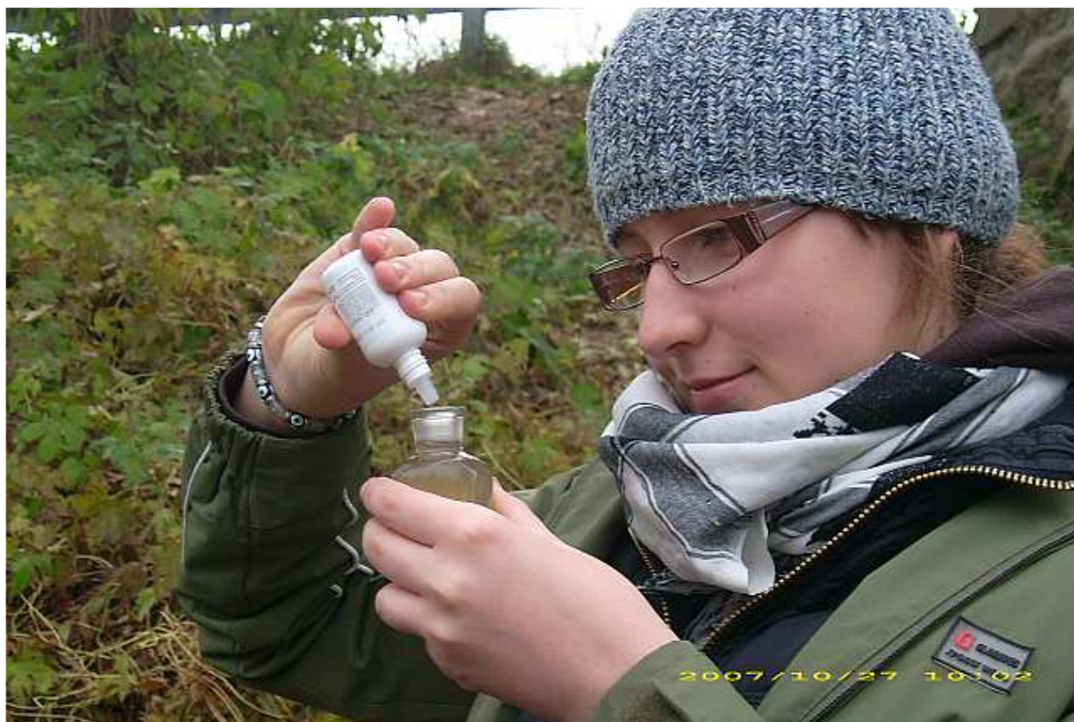
Pomiar zawartości tlenu
