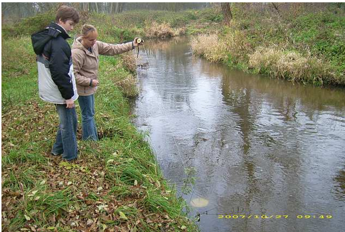
Pomiar przejrzystości wody za pomocą krążka Secciego
